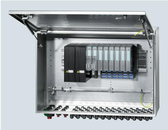
A fronte di elevate esigenze di protezione, le apparecchiature ET 200iSP possono essere installate anche in cassetta da parete in acciaio inox. Le cassette, offerte in diverse grandezze, corrispondono al grado di protezione IP65 e sono impiegabili nelle Zone Ex 1 e 2.
